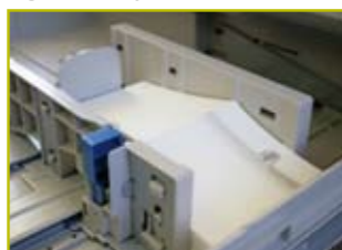
Rechte doorgang waardoor je tot 330 gram kan printen. Ook voorgerild papier, gestructureerde papersoorten en voorgestante kaartjes zijn mogelijk.
