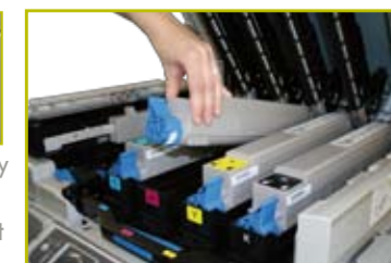
Toners kunnen in één simpele beweging worden vervangen
